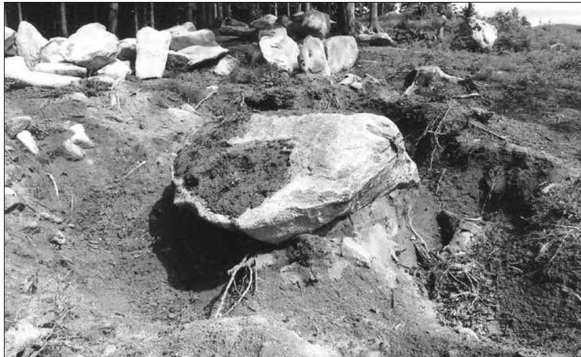
Obr. 19: Umělý odkryv na Feistově kopci s balvany v jemnozrnné zvětralině (saprolitu). Foto obr. 5–19 Jan Vítek.
