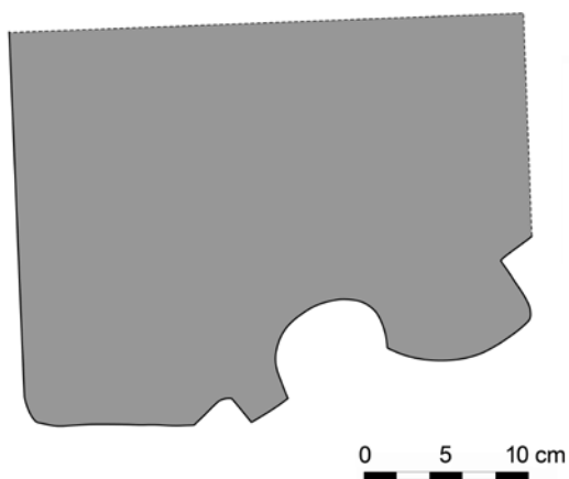
Obr. 5: Lichnice (k. ú. Podhradí v Železných horách, okr. Chrudim). Profilace přízdního klenebního žebra. Zaměření M. Kovář, překreslila H. Kovářová (2017).
